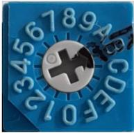
Il sensore **950N** è dotato di un trimmer **TR1** per la regolazione della sensibilità di ritiro della tenda.
